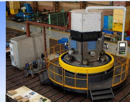
1. Разработка предусматривает проектирование структурно-компоновочной схемы станка, с разделением кинематической структуры на отдельные самостоятельные кинематические цепи с минимальным числом механических элементов, объединенных системой ЧПУ, что позволит обеспечить эффективное выполнение согласованных движений элементов в соответствии с заданной программой обработки детали;
