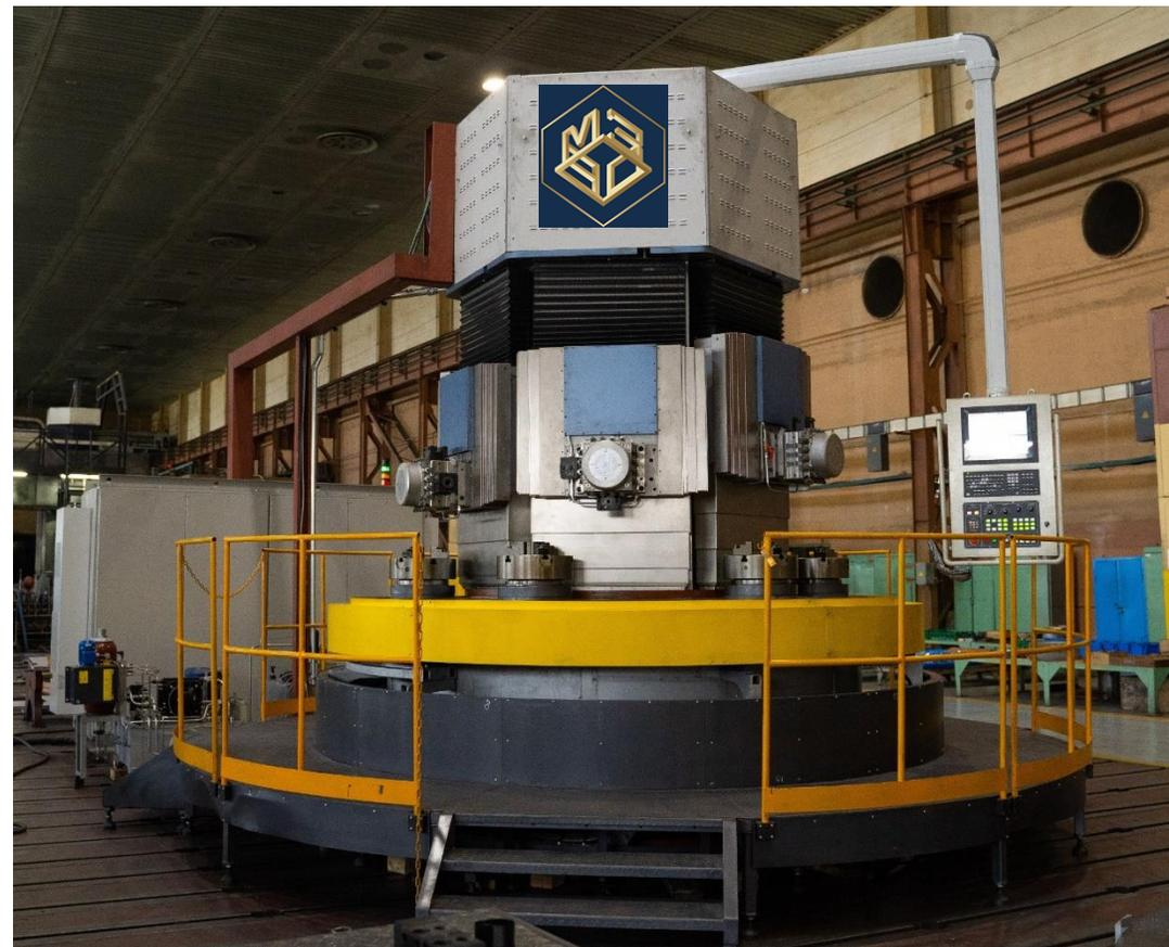
Разработка базовой модели Станка-полуавтомата вертикального токарного шестишпиндельного с ЧПУ модели **МС1М263Ф4** проводится в рамках подпрограммы «Машиностроительное оборудование» ГНТП «Инновационное машиностроение и машиностроительные технологии».
